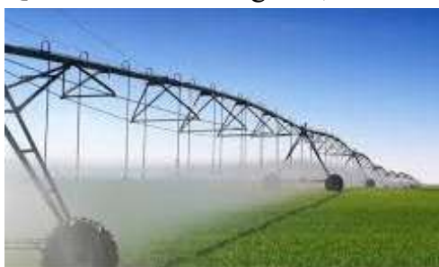
3-rasm. Pivod (pivot) aylanuvchi sug'orish tizimi.
